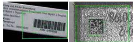
读取药品包装上的条形码 读取压铸件上的激光刻写矩阵码
